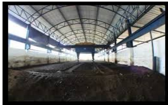
ภาพที่ 5.10 การผลิตปุ๋ยหมักแบบกองยาวใน รางซีเมนต์แบบใช้เครื่องจักร
