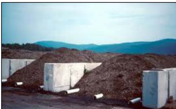
ภาพที่ 5.9 การผลิตปุ๋ยหมักแบบกองยาวใน รางซีเมนต์แบบใช้ท่อ
